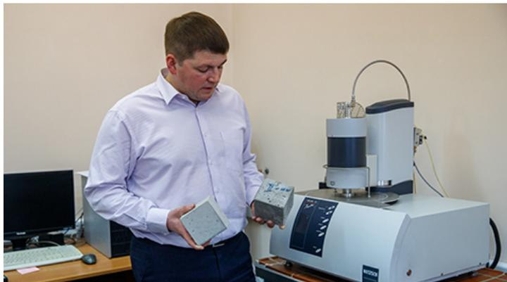
Опираясь на известное влияние гипса на процесс гидратации (то есть схватывания) цемента, специалисты провели специальные исследования и оценили, как меняется радонопроницаемость цементно-песчаного раствора после нанесения на него дополнительного слоя гипсового теста. В качестве материала для дополнительного слоя также применяли кек — гипсосодержащий отход промышленности.
