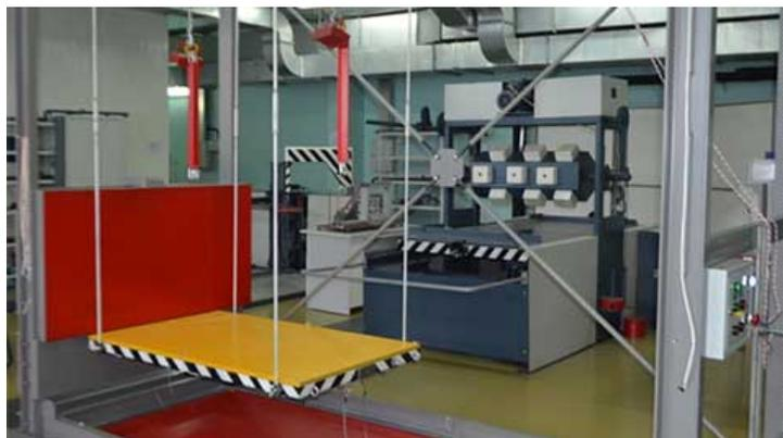
Перед авторами идеи стояла задача создания универсального, но при этом малогабаритного стенда, воспроизводящего боковые удары и падения. Такое оборудование за счёт эффективного использования площади испытательной лаборатории способно снизить себестоимость самих испытаний. При этом стенд может применяться для испытаний как картонных, фанерных, деревянных ящиков, так и бутылочной продукции, тары для жидких и сыпучих материалов, строительных мешков. На воплощение задумки потребовалось полгода.
