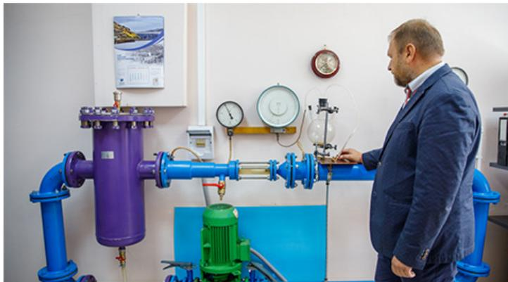
Авторы исследования разработали технологию получения пресной воды за счёт эффекта кавитации — явления, при котором в жидкости в условиях отрицательного давления образуются пустоты (кавитационные микропузырьки). При их схлопывании возникают высокие температуры до 15 тыс. градусов, образуются ударные волны до 10 тыс. атмосфер и струи в форме игл, вода в которых движется со скоростью до 500 метров в секунду. Эти эффекты широко используются в различных технологических приложениях.
