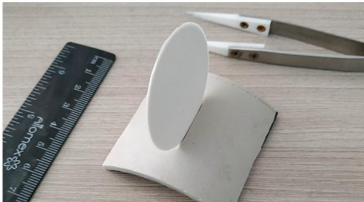
Электропроводящая керамика широко используется для создания мембран, незаменимых в пищевой и химической промышленности, в полиграфии и при производстве текстиля, энергетике и многих других отраслях, где есть необходимость очистки, разделения жидкостей и водоподготовки. Такие мембраны рассчитаны на контакт с различными химическими веществами и могут использоваться при повышенных температурах и высоком давлении, а также для сохранения высокой чистоты процесса.
