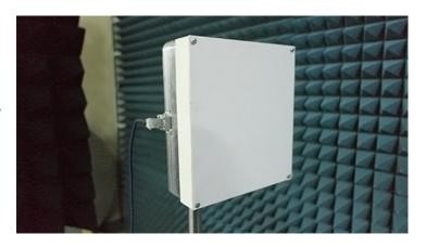
Антенная решётка будет являться составной частью новых мобильных станций спутниковой связи АО «НПО "Радиосвязь"», предназначенной для спутникового вещания в Ка и Q диапазонах.
