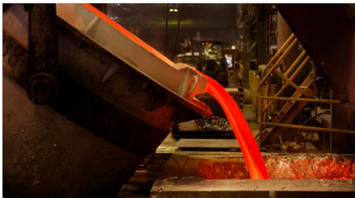
*«Процесс приготовления и литья сплава — процедура длительная, на протяжении которой непрерывно происходит потребление электрической энергии промышленными печами — одними из мощнейших видов технологического оборудования. Для ускорения этого процесса прибегают к различным способам, среди которых электромагнитные являются наиболее технически осуществимыми, так как не требуют прямого контакта с жидким металлом», — отметил руководитель проекта, профессор СФУ **Виктор Тимофеев.***
