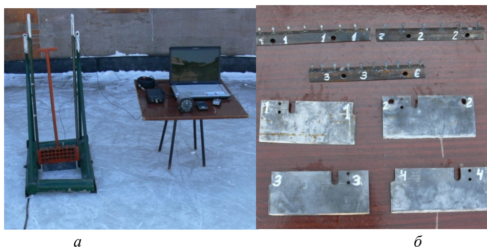
Рис. 1. Стенд ударного разрушения снежно-ледяных образований: а – оборудование для исследований и регистрации параметров; б – рабочие органы
