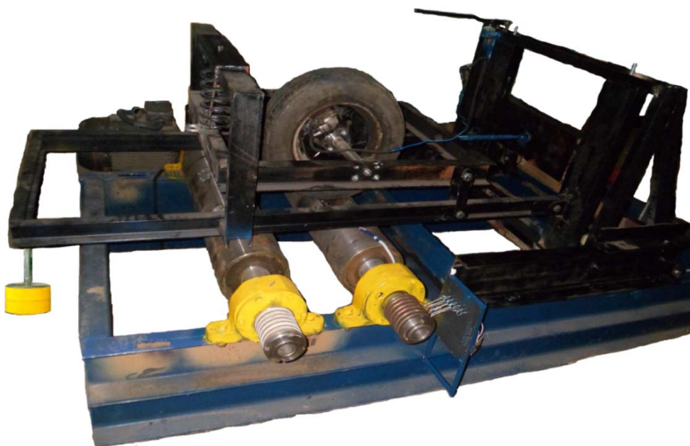
Рис. 1. Общий вид стенда для определения напряжений в пятне контакта колеса с опорной поверхностью бегового барабана, установленный НИ ИрГТУ в лаборатории диагностики кафедры «Автомобильный транспорт»
