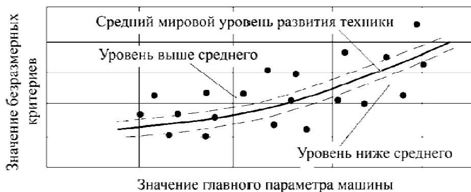
Рис. 2. Поле корреляции критериев оценки технического уровня машин на основе пространственно-временных математических моделей
