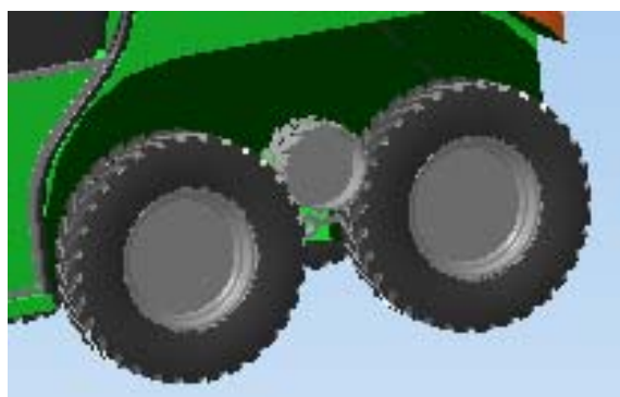
Рис. 3. Роликовый фрикционный привод ведущих колес проектируемого ТС
