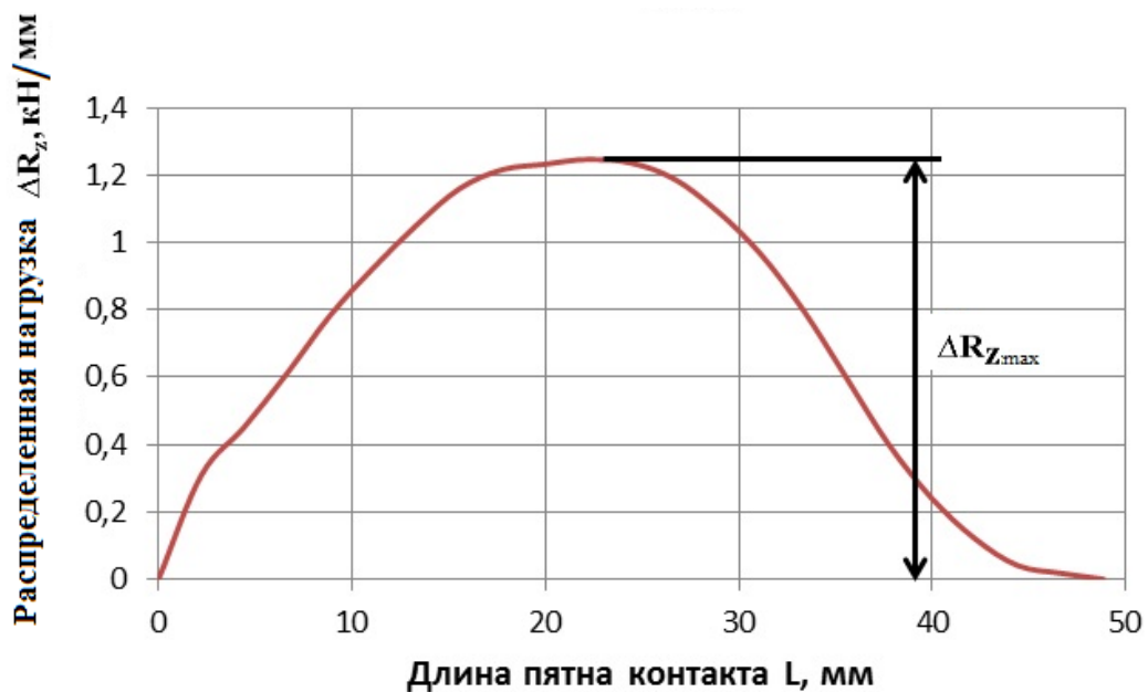
Рис. 10. Эюра распределения нормальной реакции в пятне контакта эластичной шины при качении колеса по цилиндрической поверхности бегового барабана диагностического стенда диаметром 0,24 м (давление в шине – 0,21МПа)
