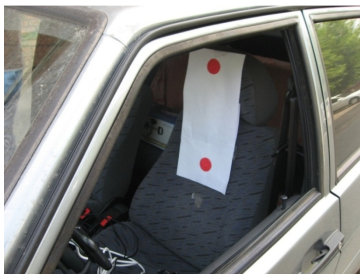
Рис. 8. Размещение экрана с красными метками на спинке водительского сиденья в фокусе первой веб-камеры
