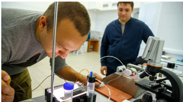
Для измерения вязкости предполагается использовать микрофлюидный вискозиметр — прибор для определения динамической или кинематической вязкости вещества. Разработанный сибирскими учёными вискозиметр работает благодаря использованию так называемых вихрей Дина. Это «поперечные» потоки, возникающие в изогнутом канале, по которому движется жидкость.
