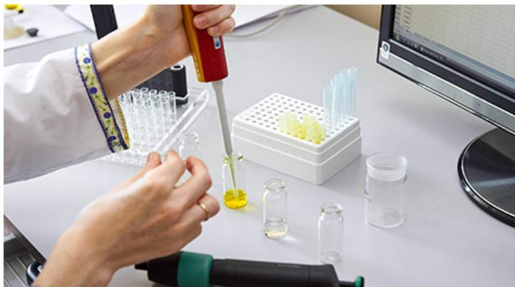
Основным компонентом биосенсора, над которым работают учёные СФУ, является биомодуль, представляющий собой ферменты светящихся организмов. В благоприятных условиях ферменты испускают свет, который фиксирует специальный прибор — люминометр. Однако в присутствии токсических веществ, это свечение снижается. По интенсивности испускаемого света учёные могут судить о качестве или безопасности той или иной продукции.
