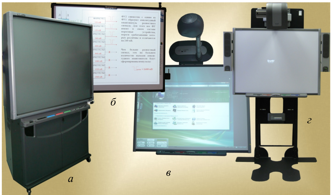
Рис. В1. Примеры интерактивных досок, используемых в образовательном процессе Сибирского федерального университета: а – система обратной проекции SMART Board 3000i ; б – система прямой проекции InterWrite Board ; в – система прямой проекции SMART Board 680i ; г – мобильная система прямой проекции SMART Board 660i2
