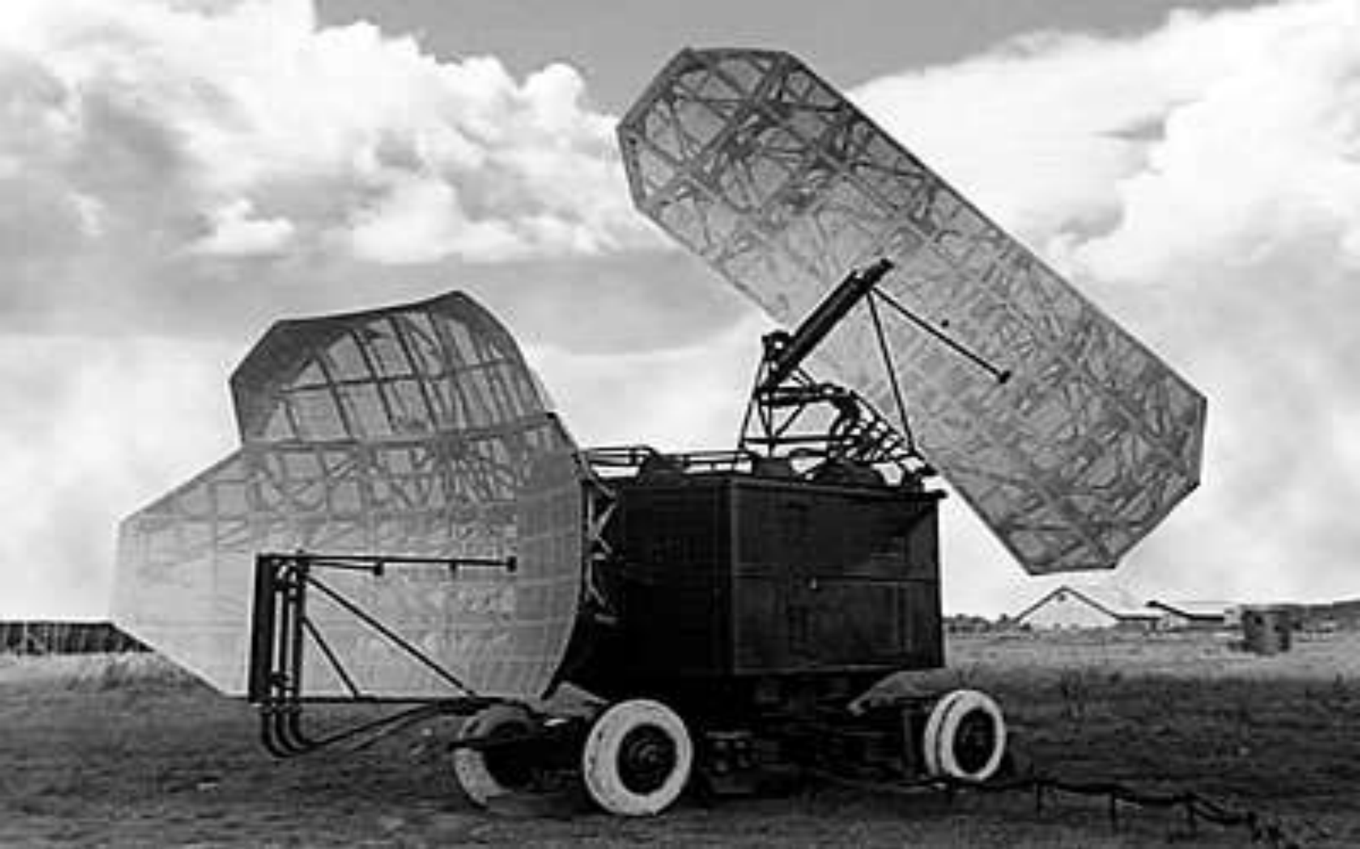
РЛС П-20 «Перископ» - первая РЛС дальнего обнаружения и наведения сантиметрового диапазона волн (1950 г.)
