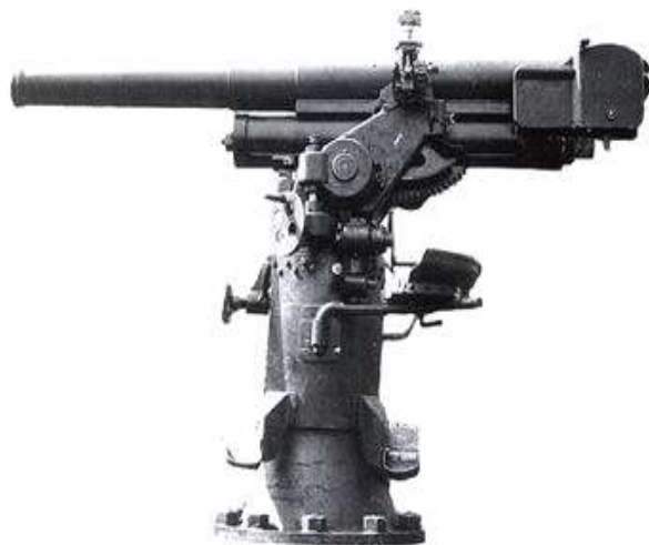
3-дюймовое полевое орудие обр. 1902 г., приспособленное для стрельбы по воздушным целям (1914 г.)
