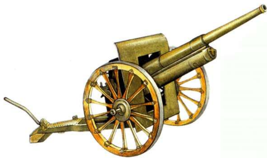
3-дюймовое полевое орудие обр. 1902 г., приспособленное для стрельбы по воздушным целям (1914 г.)
