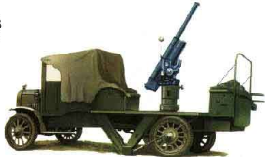
3-дюймовое полевое орудие обр. 1902 г., приспособленное для стрельбы по воздушным целям (1914 г.)
